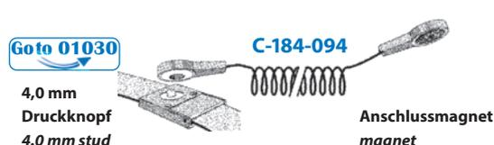
Der Tenaxverschluss ist eine Art Druckknopf mit auslösender Selbstsicherung. Wenn er durch Druck geschlossen wurde, sind Ober- und Unterteil so fest miteinander verbunden, dass sie ohne Betätigung der Verschlussperre nicht wieder getrennt werden können. Der Tenaxverschluss wird eingesetzt, wenn ein unbeabsichtigtes Lösen des Erdungskabels vom Masseanschluss unbedingt vermieden werden muss. Dies ist z. B. in der Autoelektrik gefordert. /
