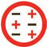
Die Core Insight Autobalance Technologie regelt automatisch die Abgabe von positiven und negativen Ionen zur optimalen Neutralisierung der entstandenen Ladung.
