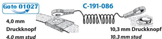
**Standardanschluss für Erdungsarmbänder ist der 4,0 mm Druckknopf. Er ist international kompatibel. Für den Masseanschluss stehen verschiedene Kontaktierungsmöglichkeiten zur Auswahl (Auf Wunsch andere Kontaktierungen möglich).**
