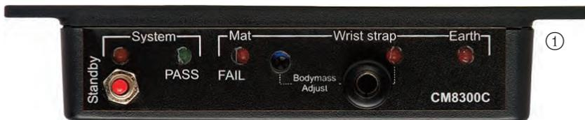
Der **CONSTANT MONITOR** überwacht im elektrostatisch geschützten Bereich (EPA) die Parameter Erde, Matte und Armband. Ist die Kette "Erdung - Tischmatte - Kabel - Armband" unterbrochen ertönt ein akustisches Signal. Der Status der Störung wird auf dem Display angezeigt. (① Montage unter dem Tisch / ② Montage auf dem Tisch).
