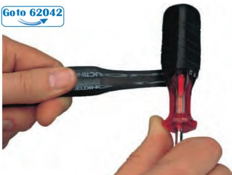
Selbstverschweißendes, ableitfähiges Vulkanisierband zum schnellen und einfachen Umwandeln von vorhandenen, herkömmlichen Werkzeugen wie z. B. Schraubendreher o. ä. in ESD-gerechtes Werkzeug. Der abzudeckende Griff oder Gegenstand wird spiralförmig mit Shielding Tape umwickelt. Nach ca. 30 Minuten ist das Band vollständig aufvulkanisiert und bildet nun eine ESD-gerechte, ableitfähige Schutzhülle.
