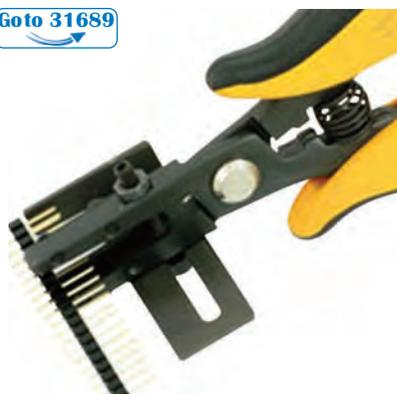
Spezialzange zum Schneiden von geraden oder abgewinkelten Stift-leisten. Die Abschneidlänge kann auf unterschiedliche Raster eingestellt werden (min. 3 mm - max. 35 mm). Schneide für abgewinkelte Stiftleisten ist im Lieferumfang enthalten.
