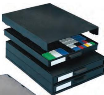
3-fach Schubladenschrank aus leitfähigem Polystyrol (Oberflächenwiderstand ca. 10<sup>5</sup> Ω) zur Aufbewahrung der SMD-Kleinbehälter. Bestehend aus einer Fußplatte, Aufbaurahmen im Stecksystem und drei Schubladen (stapelbar). Der Schrank ist durch einfaches Aufstecken weiterer Aufbaurahmen beliebig erweiterbar.
