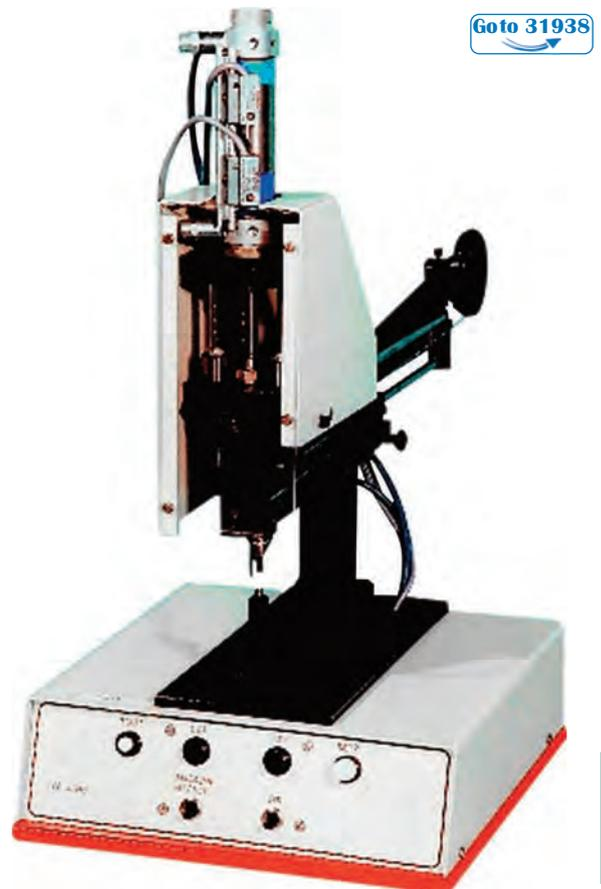
**Lieferumfang / scope of delivery:** Maschine, Magazin, Einsatzkopf, Abdeckplatte, Einsatznadeln
