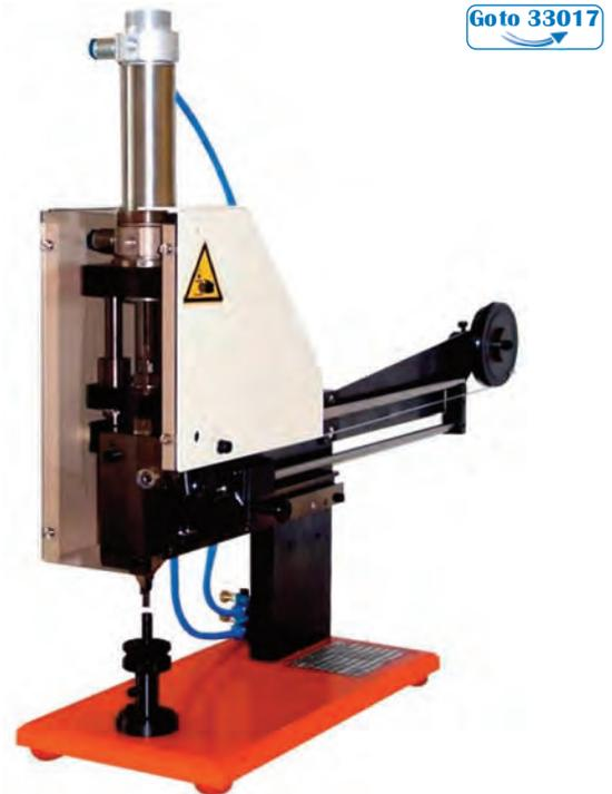
**Lieferumfang / scope of delivery:** Maschine, Magazin, Einsatzkopf, Abdeckplatte, Einsatznadeln
