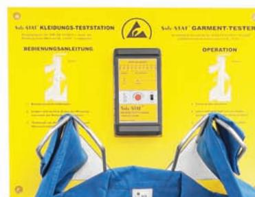
Die **Safe-STAT® Kleidungs-Teststation** wurde mit dem Ziel entwickelt, ESD-Kleidung im täglichen Einsatz schnell und unkompliziert auf deren Funktionsfähigkeit hin zu überprüfen.
