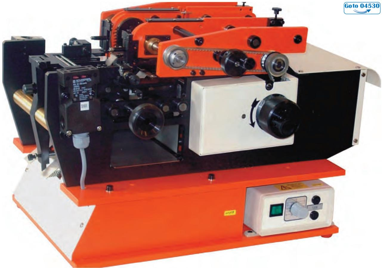
Bei dem Automaten Typ **C 043 E** können über Verstellspindeln sowohl Schneidlänge als auch Raster eingestellt und die Bauteile anschließend bearbeitet werden. Die Einstellung wird an der jeweiligen Skala der Vorrichtung angezeigt. Über eine optionale Digitalanzeige kann die Einstellung überwacht werden. Die Prägungen für die Anschlussbeinchen sind werkzeugspezifisch und werden nach Kundenanforderung angefertigt.
