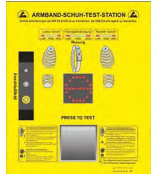
Als Messgerät dient die **Safe-STAT® 5000**-Test-Station (siehe Seite 20), die in das Gehäuse der Drei-Arm-Sperre integriert wird. Nach Identifizierung des Nutzers wird durch Betätigung eines Tasters die Messung gemäß hinterlegtem Benutzerprofil durchgeführt. Der jeweilige Nutzer kann sich an den großen grafischen Symbolen für LOW, PASS und HIGH orientieren, die im Display angezeigt werden. Sowohl beim Ein- als auch beim Ausgang werden durch Piktogramme die jeweiligen Laufrichtungen angezeigt.
