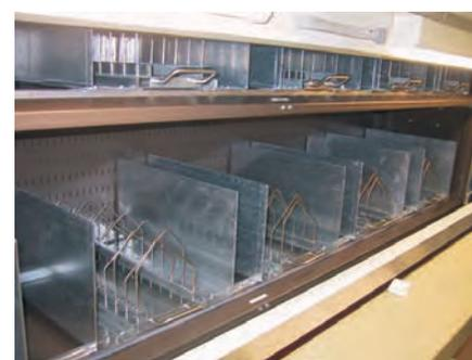
Aufgrund der besonderen Konstruktion eignen sich diese SMD-Spulenständer hervorragend für die Einlagerung in Paternostern, Regalen oder Klimaschränken (auf Wunsch auch mit Teleskopauszugsschienen).
