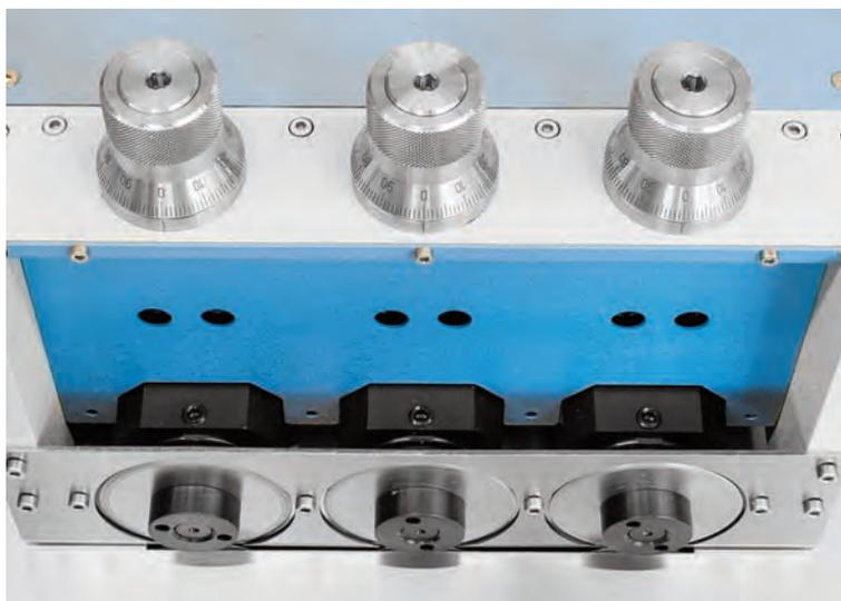
Jedes der Messerpaare (ein Messer oben, ein Messer unten) kann mit einer speziellen Justier Vorrichtung einzeln eingestellt werden.
