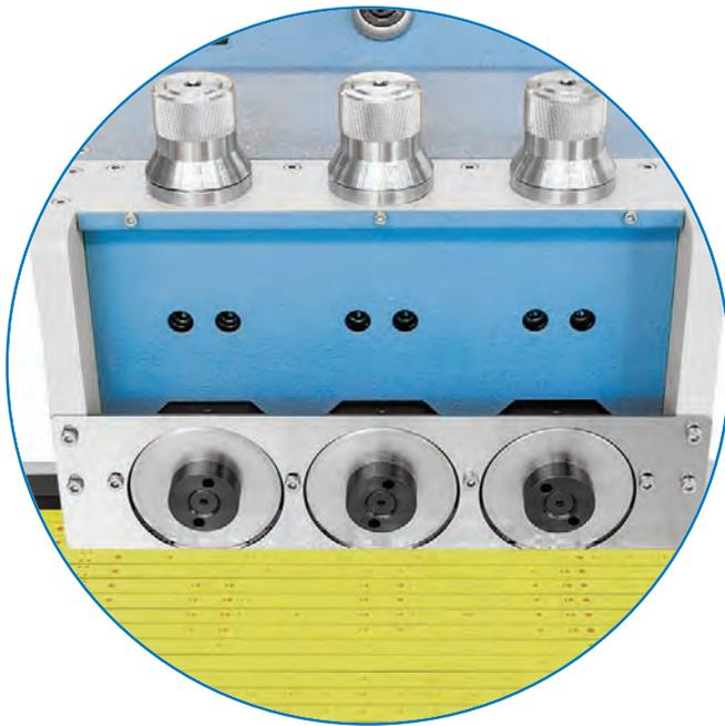
Das dreistufige Trennverfahren ist insbesondere für Aluminiumnutzen entwickelt worden. Selbstverständlich können jedoch auch Standardnutzen wie z. B. FR4 getrennt werden.
