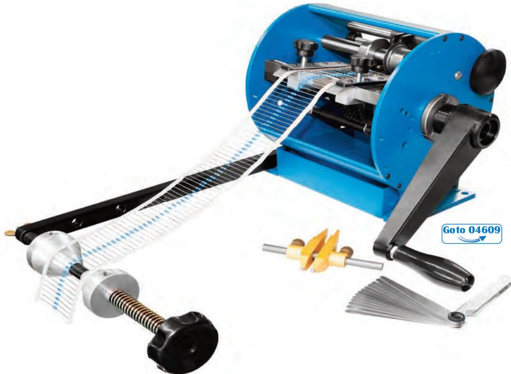
Die Bauteilvorbereitungsmaschinen der Serie „TP“ zeichnen sich durch hervorragende Verarbeitung, sehr robuste Ausführung, einfachste Einstellbarkeit und hohe Standzeiten aus. Die Grundmaschinen sind mit einer Handkurbel für manuellen Antrieb und einem Abrollständer für Gurtrollen ausgerüstet. Nach Bedarf können die Maschinen (auch nachträglich) mit einem Motorantrieb und einer Zuführeinheit für lose axiale Bauteile ausgerüstet werden.
