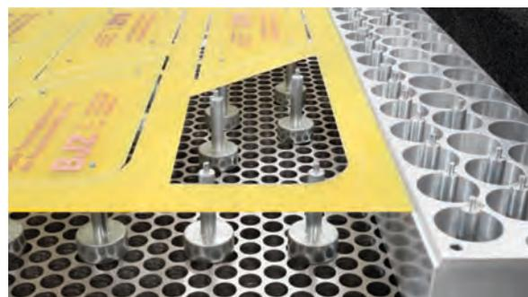
Detailaufnahme der Magnetstützen /
