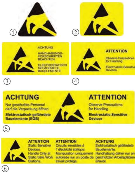
ESD-Etiketten nach DIN EN 61340, Lieferform: Rollen / ESD labels according to IEC 61340, rolls
