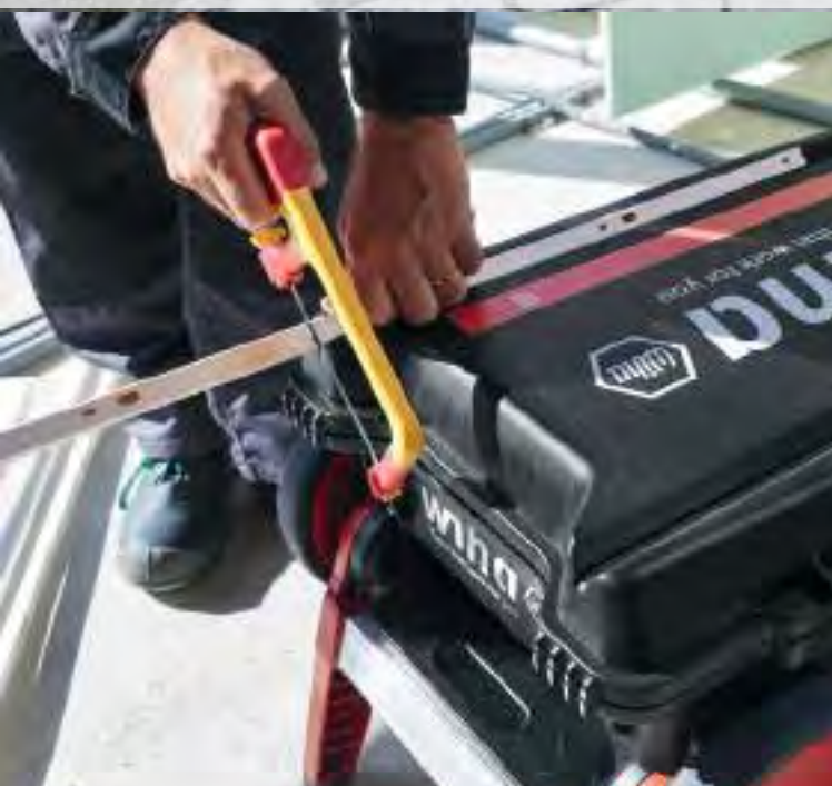
V-formede hakk med skala i koffertlokket
